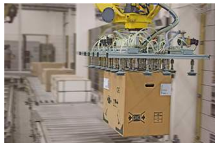
Сильфонные присоски FSGA для перемещения картонных коробок
